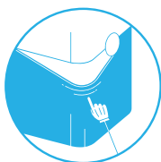
プレフィルター (2枚) プレフィルターを装着 すると、大きなホコリを キャッチすることができます。
