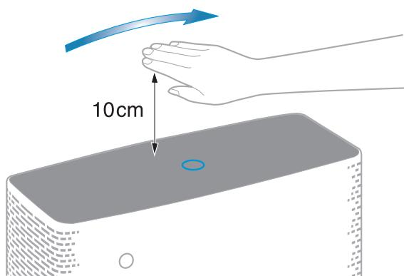
11 天面ガラスに点灯している**CHANGE FILTER**（フィルター交換お知らせ）ランプを長押しし、ランプが4回点滅したら指を離す。
