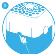
3 両側面の取り外しボタンをカチッと音がするまで軽く押します。
