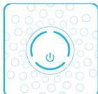
操作ボタンを 1 回押すと、本体の電源がオンになり、オートモードで稼動します。
