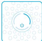
操作ボタンを 2 回押すと、低速(ナイトモード)で稼動します (LED が消灯します)。
